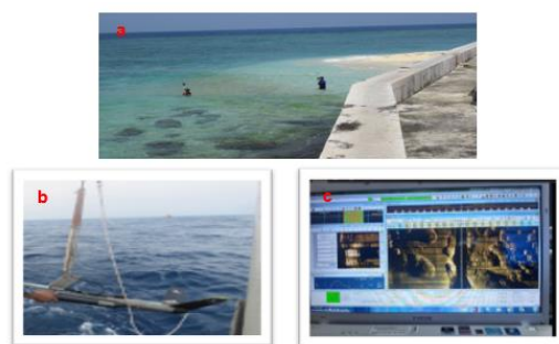
Hình 2: Đo sâu bằng sào (a), quét Side Scan Sonar bằng máy Klein 3000 (b) và quá trình thu thập dữ liệu đo sâu bằng phần mềm Hypack (c)
