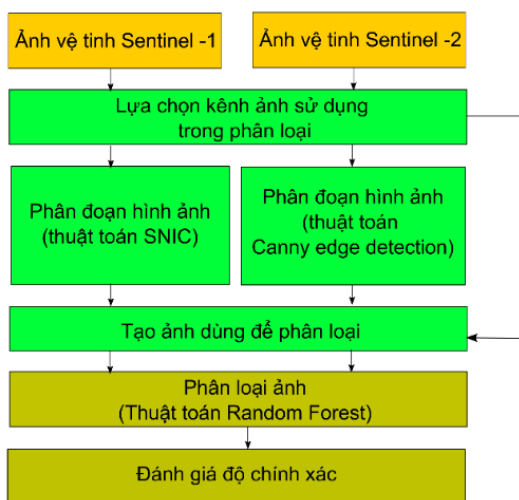
Hình 1: Sơ đồ quy trình phân loại ảnh kết hợp phương pháp phân loại dựa trên điểm ảnh và dựa trên đối tượng
