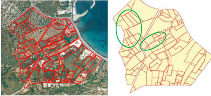
Hình 6: So sánh các thửa đất giữa tình nguyên viên vẽ trên PDA (màu đỏ) và cán bộ kỹ thuật địa chính vẽ trên Decktop (màu xanh lam). (Nguồn: Apostolopoulos và cs, 2018)
