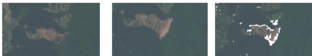
Hình 3: Ảnh vệ tinh trước, sau và kết quả phân vùng khi theo dõi sạt lở
