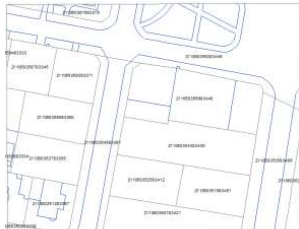
Hình 1: Mã định danh thửa đất sử dụng tọa độ địa lý tâm thửa xác định trong VN2000 [6]
