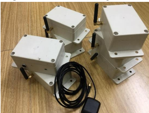
Hình 3: Sản phẩm thiết bị quan trắc và phần mềm tự động thành lập, xuất bản dữ liệu tiếng ồn trực tuyến, thời gian thực
